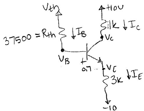
$$-V_{th} + I_B (37500) + 0.7 + I_E (3k) - 10 = 0$$
