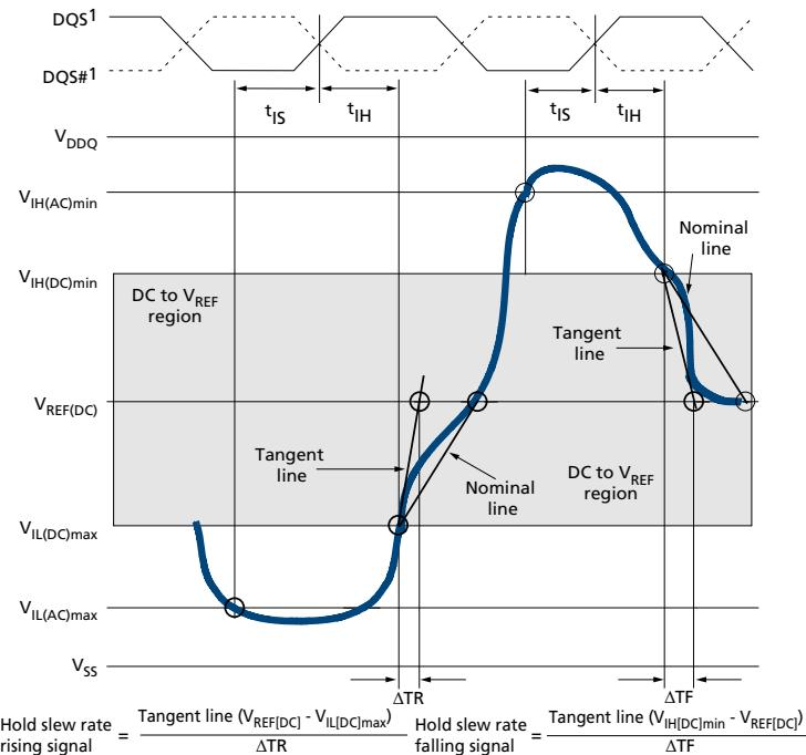
Note: 1. DQS, DQS# signals must be monotonic between  $V_{\text{IL(DC)max}}$  and  $V_{\text{IH(DC)min}}$ .
