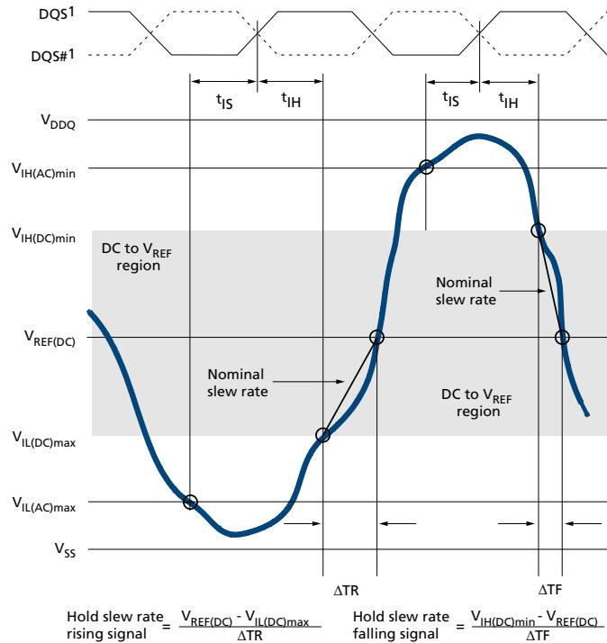
Note: 1. DQS, DQS# signals must be monotonic between  $V_{\text{IL(DC)max}}$  and  $V_{\text{IH(DC)min}}$ .
